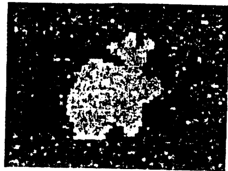
그림12. 표준편차 25의 가우시안 잡음이 내포된 영상. Image added Gaussian noise with a standard deviation of 25.
