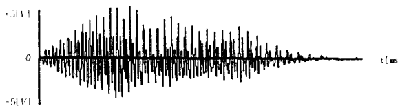
그림 1. 음성신호파형(발성을 "일") Fig 1. Speech signal waveform(utterance of "il")
