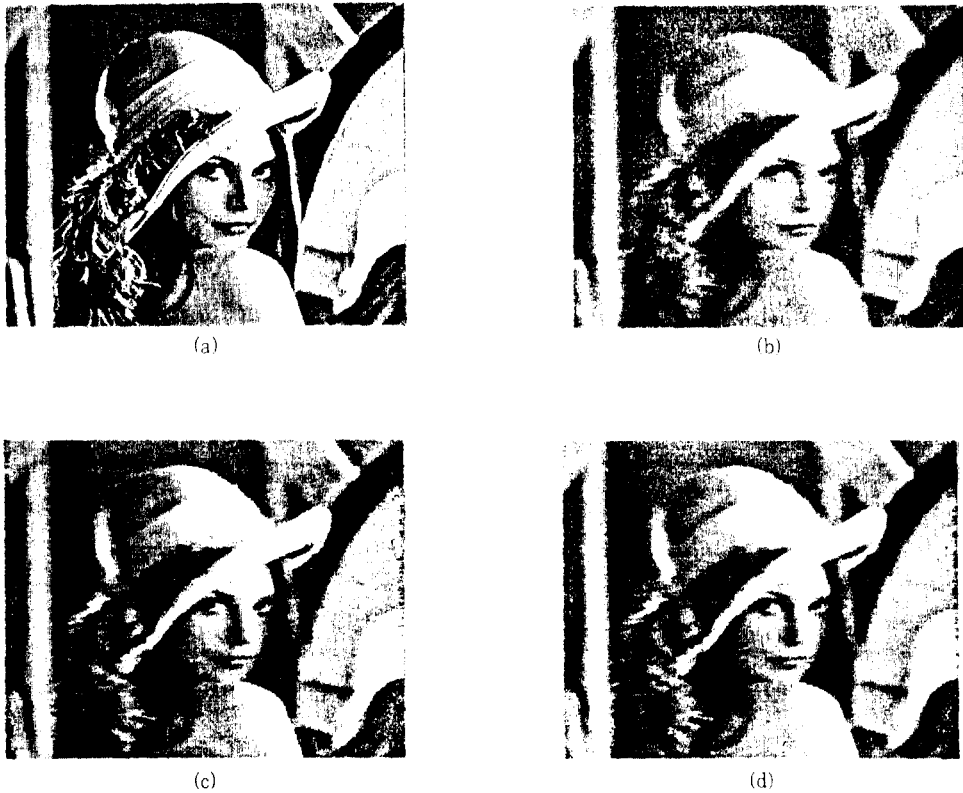
그림 4. (a) 원 영상 : Lena Image (b) 훼손된 영상 : 움직임에 기인한 흐려짐, 15dB의 백색잡음 PSNR=22.16, MSE=394 (c) 휴필드 신경회로망을 이용하여 복원한 영상 : 45회 반복 PSNR=23.69, MSE=277 (d) 시뮬레이티드 어닐링 기법을 이용하여 복원한 영상 : 45회 반복 PSNR=23.86, MSE=269
