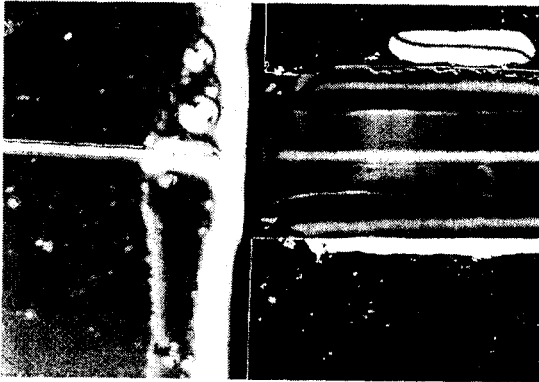
사진 8. V-groove에 광섬유를 고정시킨 후 도파로의 결합한 표면 Photo 8. The surface coupling with waveguide after optical fiber fixed on V-groove
