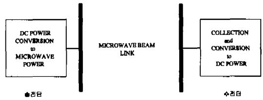
그림 1. 무선전력전송 시스템 구성도
