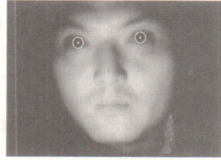
그림 5. 피라미드 탐색 기반 원형 경계 검출 알고리즘에 의해 찾은 눈의 경계 및 중심 위치 Fig. 5. The detected eye circles and eye centers by circular edge detection with pyramid search
