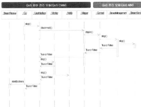
그림 22. 접속 해제 수행 절차의 시퀀스 다이어그램
