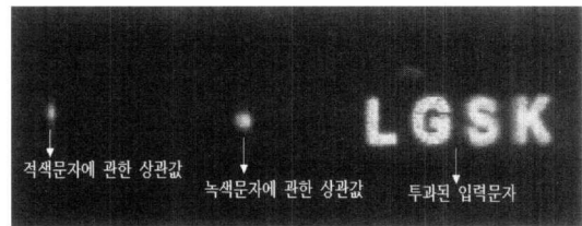
그림 5. 적색의 “L”, “G”와 녹색의 “S”, “K”가 입력될 때 CCD의 검출 결과
