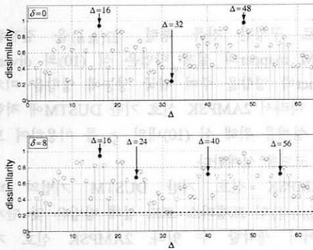
그림 4. 2A32PSK 신호 기반 DUSTM 기법의 dissimilarity값 분포와 부집합 내 dissimilarity값 비교 ( $\delta=0, 8$ ).
