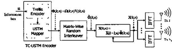
그림 1 OFDM 시스템 기반의 TC-DUSTM의 전송단 구조
