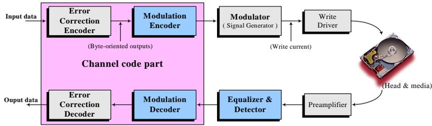
그림 1. 자기 기록 및 재생을 위한 신호처리 블록도
