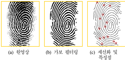
(a) 원영상 (b) 가보 필터링 (c) 세션화 및 특징점 (a) Original image (b) Gabor filtering (c) Thinned image and extracted minutiae 그림 6. 영상 센서를 통해 얻은 영상에 대한 처리 결과 Fig 6. Process result obtained by image sensor
