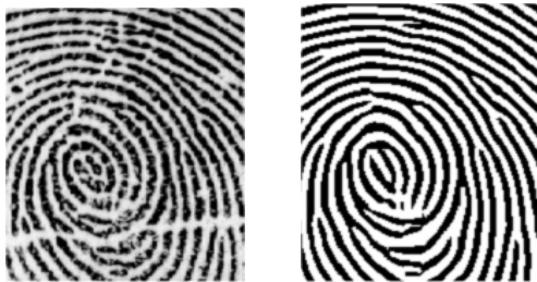
(a) 원 영상 (b) 이진화 영상 (a) Original image (b) Binarized Image 그림 2. 가보필터를 이용한 이진화 결과 영상 Fig 2. Binarized result image using Gabor Filter
