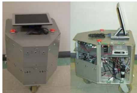
그림 8. 스테레오 초음파 센서가 장착된 자율주행 로봇 Fig. 8. Mobile robot with stereo ultrasonic sensor installed
