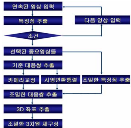
그림 1. 제안된 알고리즘의 전체적인 시스템 구성도 Fig. 1. Overall System Flowchart of proposed algorithm
