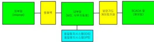
그림 6. SCADA 망에 대한 보안설계 구성도
