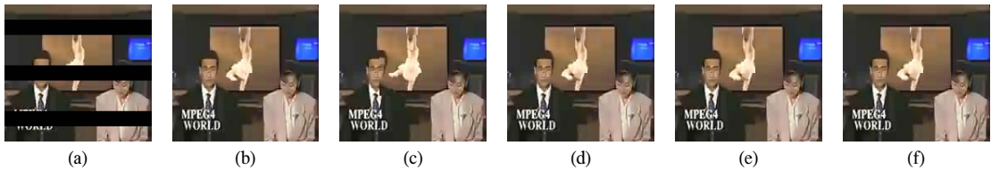
그림 12. News QCIF 영상의 화질 비교 (a) 손실된 매크로 블록 위치, (b) Temporal Replacement, (c)Block Boundary Matching, (d)Mean, (e)Median, (f)Alpha Trimmed Mean
