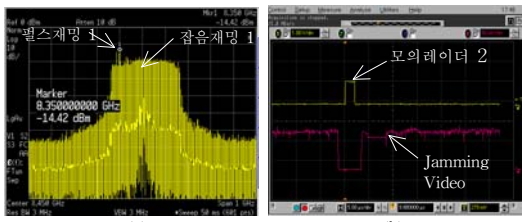
그림 7. 실험1(b)의 측정결과(제안 방법) (a) 모의 레이더신호1,2의 재밍 스펙트럼 (b) 모의 레이더신호 2와 잡음재밍의 비디오신호
