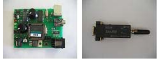
그림 10. USB 디바이스와 Serial-to-BT
