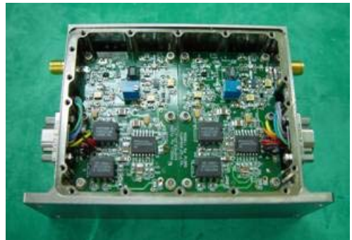
그림 3. 기본 주파수 발생부의 위상 고정 회로부 Figure 3. Phase locking part of Fundamental Frequency Generation Module
