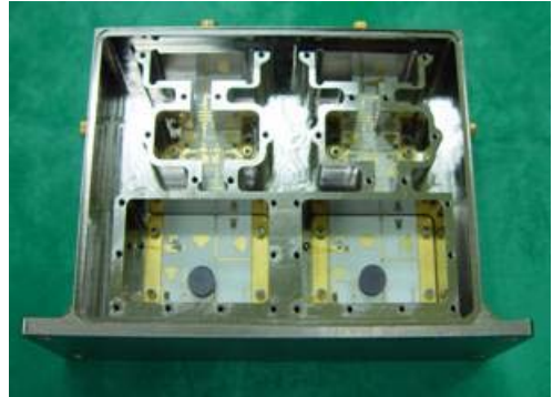
그림 2. 기본 주파수 발생부의 RF부 Figure 2. RF part of Fundamental Frequency Generation Module
