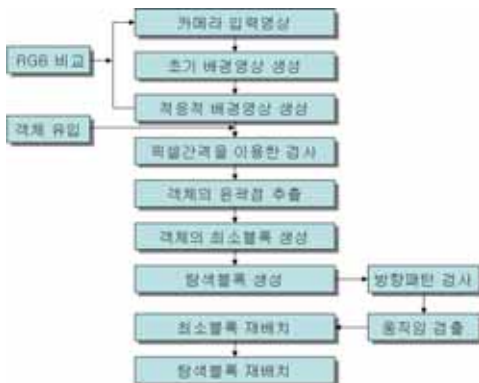
그림 5. 움직임 검출 과정 Fig. 5. Motion detection process
