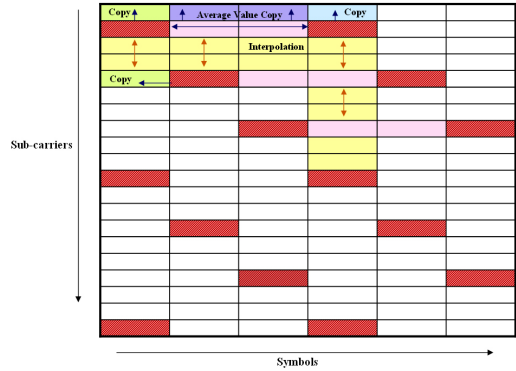
그림 14. 채널 추정 방법 (Av. & Copy). Fig. 14. Channel estimation method (Av. & Copy).
