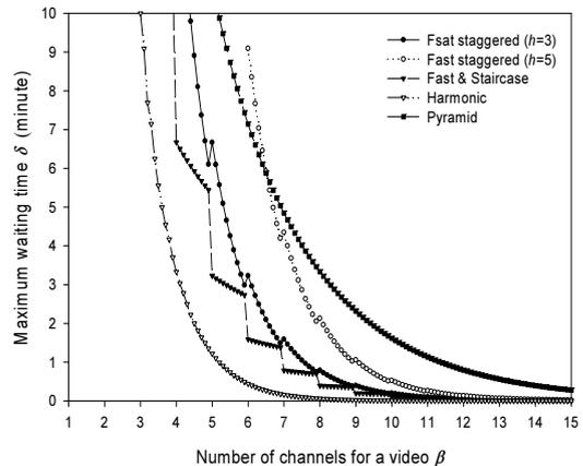
그림 4. Fast Staggered 방식과 기존 NVoD 방식의 시청자 최대 대기시간 비교 (비디오 길이  $D$ 는 100분, Fast Staggered :  $h(=n)$ 는 3과 5)
