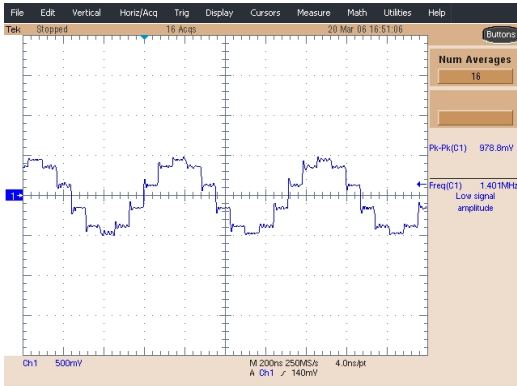
그림 13. 톤 주파수의 DAC 시스템 출력파형 Figure 13. Output waveform from DAC system of tone frequency
