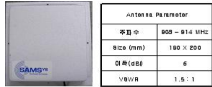
그림 14. SAMsys 안테나의 전면도 및 안테나 파라미터
