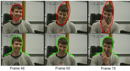
그림 7. Camshift[11]의 결과(첫째열)과 제안된 기법의 결과(둘째열)의 비교
