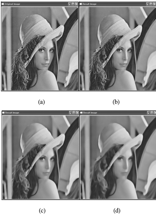
그림 2. 페로나 확산 모델을 이용한 처리 결과 : (a) 원영상, (b) 10회 반복, (c) 50회 반복, (d) 100회 반복. Fig. 2. Diffusion results based on Perona model : (a) original image, (b) after 10 iteration, (c) after 50 iteration, (d) after 100 iteration.
