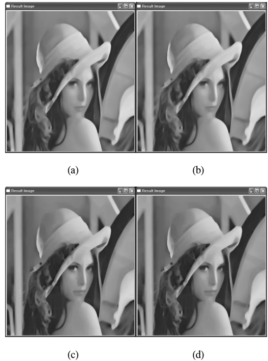
그림 3. 기존의 확산 모델 비교 : (a) 페로나 확산 모델 (100회 반복), (b) 바르셀로즈 확산 모델 (100회 반복), (c) 페로나 모델 + Median 필터 (30회 반복), (d) 바르셀로즈 모델 + Median 필터 (30회 반복). Fig 3. Comparison of diffusion performance : (a) Perona diffusion model (after 100 iteration), (b) Barcelos model (100회 iteration), (c) Perona model + Median filtering (30회 iteration), (d) Barcelos model + Median filtering (30회 iteration).
