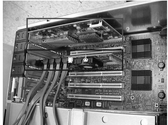
그림 4. AMD 시스템(10 기가급 네트워크 장치(상단), 레이드 디스크 제어장치(하단))
