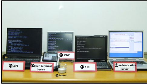
그림 8. 지문을 이용한 사용자 인증 시스템 구현
