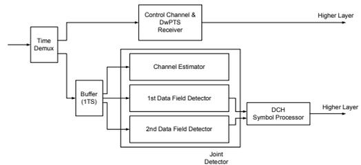
그림 2. TDD HSDPA 단말시스템의 수신 블록다이어그램
