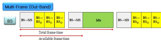
그림 9. Multi-frame 방식 MMR 시스템의 프레임 효율 정의
