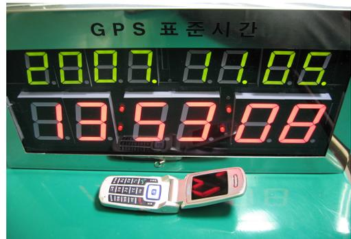
그림 9. 분석 전·후의 전파 유입여부를 확인하기 위한 국제표준시계
