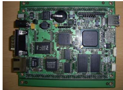
그림 10. 차량용 자가진단 임베디드시스템
