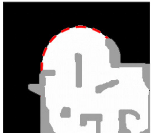
그림 2. 프론티어 셀. 회색이 장애물, 백색이 빈공간, 검정색이 미탐색, 점선이 프론티어셀 Fig. 2. Frontier cell. Black denotes unexplored area; white, vacancy; grey, obstacle; dotted line, frontier cell
