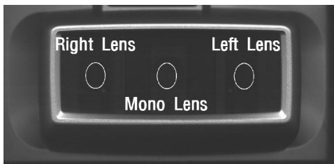
그림 3. 단일 카메라의 모노-스테레오 렌즈 Fig. 3. Mono-stereo camera lens of single camera
