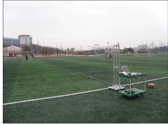
그림 15. 장거리 센서태그 시스템의 무선 인식거리 시험
