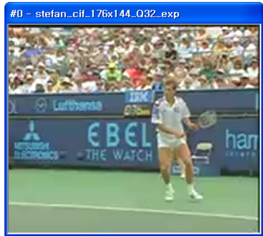
그림 3. 결과 화면의 주관적 화질 비교: 원본 CIF 해상도, 23.99 dB (위), QCIF 디코딩 후 CIF로 확대, 23.79 dB (아래)
