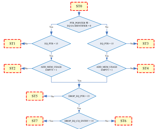
그림 4. Enqueue Pointer Controller State Diagram
