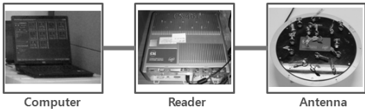
그림 2. 900 Mhz 근거리 인식용 RFID 시스템 구성도 Fig. 2. 900 Mhz Near field RFID System structure
