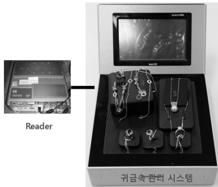
그림 12. 귀금속 인식 시험을 위한 시스템 구성 Fig. 12. The system to recognition test of the jewelry
