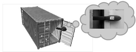
그림 3. ConTracer 부착 위치
