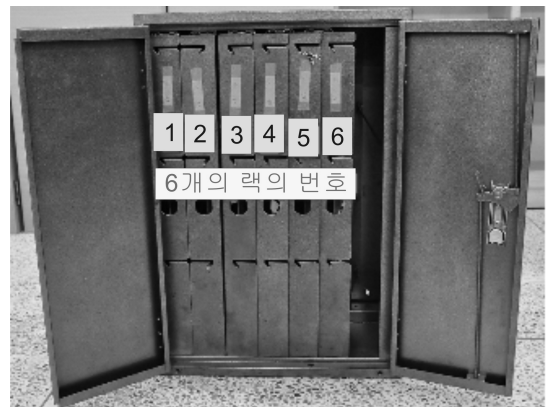
그림 1. 열쇠 보관용 캐비닛안에 6개의 서랍식 랙 Fig. 1. Drawer type 6 racks in a Key management cabinet
