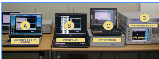
그림 11. 무선인지 시스템 실제 구성 사진
