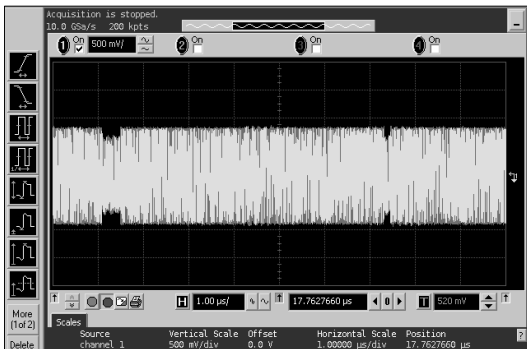
그림 19. 변조기 동작에 따른 태그 칩 입력신호 파형
