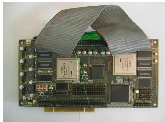
그림 5. PCI 인터페이스 회로 테스트용 FPGA 보드
