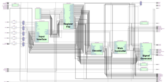
그림 13. TACAN FPGA의 전체 합성도 Fig. 13. Top synthesis result of TACAN FPGA
