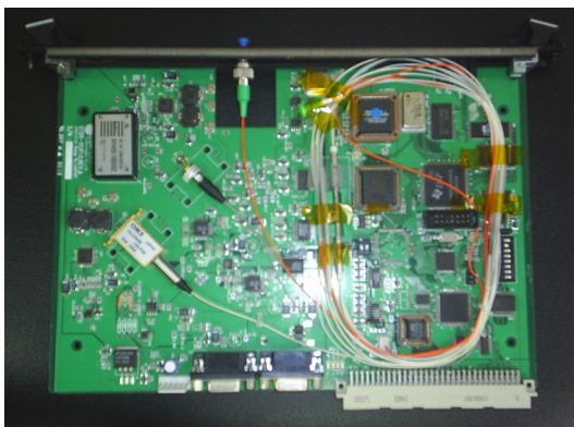
그림 5. 제작된 스위치 내장형 OTDR
