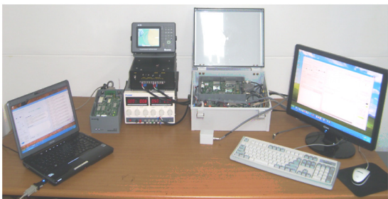
그림 7. AtoN AIS의 성능실험 Fig. 7. performance test of AtoN AIS
