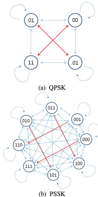
그림 4. 변조기법 (a) QPSK, (b) PSSK
