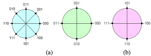
그림 1. 성상도, (a) 8-PSK, (b) 8-PSSK
