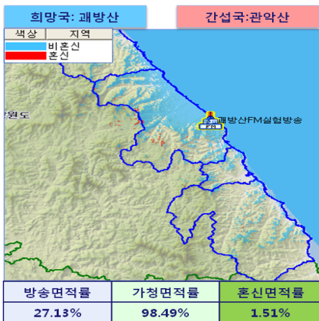
그림 5. 폐방산이 관악산SBS으로부터 받는 간섭 분석 결과 (동일채널 Case 1) Fig. 5. A result of the interference analysis from Mt.Gwan-ak SBS to Mt.Gwaebang (co-channel Case 1)
