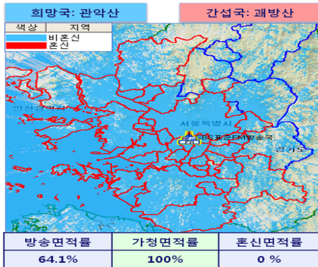
그림 10. 관악산SBS가 패방산으로부터 받는 간섭 분석 결과 (동일채널 Case 3) Fig. 10. A result of the interference analysis from Mt.Gwae-bang to Mt.Gwan-ak SBS (co-channel Case 3)
