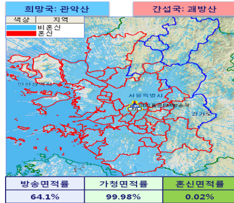
그림 6. 관악산SBS가 폐방산으로부터 받는 간섭 분석 결과 (동일채널 Case 1) Fig. 6. A result of the interference analysis from Mt.Gwaebang to Mt.Gwan-ak SBS (co-channel Case 1)
