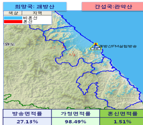
그림 7. 폐방산이 관악산SBS으로부터 받는 간섭 분석 결과 (동일채널 Case 2) Fig. 7. A result of the interference analysis from Mt.Gwan-ak SBS to Mt.Gwaebang (co-channel Case 2)
