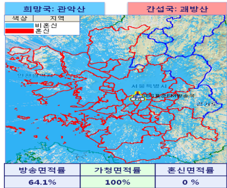
그림 12. 관악산SBS가 패방산으로부터 받는 간섭 분석 결과 (동일채널 Case 4) Fig. 12. A result of the interference analysis from Mt.Gwae-bang to Mt.Gwan-ak SBS (co-channel Case 4)
