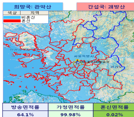
그림 8. 관악산SBS가 폐방산으로부터 받는 간섭 분석 결과 (동일채널 Case 2) Fig. 8. A result of the interference analysis from Mt.Gwaebang to Mt.Gwan-ak SBS (co-channel Case 2)
