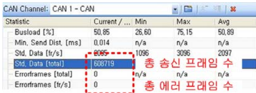
그림 7. 송, 수신간 에러율 Fig. 7. Error rate between transmission and reception
