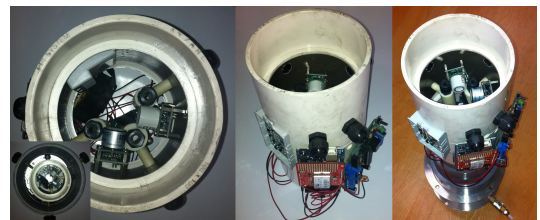
그림 12. u-EMS 노드를 부착한 가스 배출관과 표준가스 공급장치(우)
