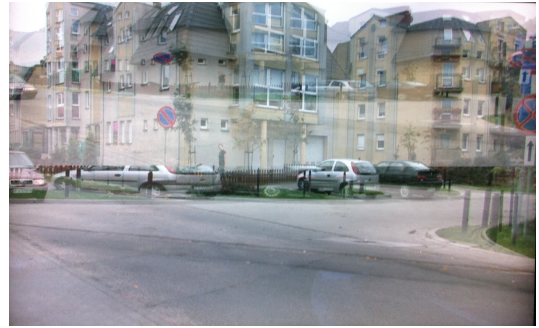
그림 11. 부호화된 영상의 해상도와 upsampling_factor가 불일치에 의한 오작동 예
